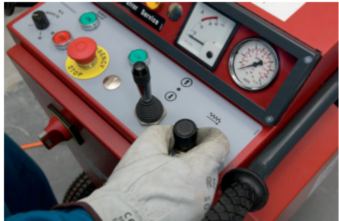
Ajuste de la presión de avance (DS WS10-E).
