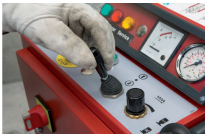
Operación de la válvula de control de avance (DS WS10-E).
