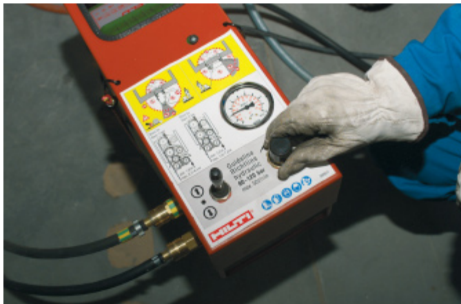
Ajuste de la presión de avance (DS WS10).
