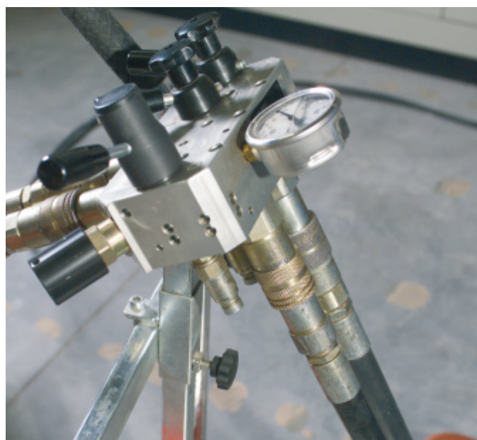
Conecte las mangueras hidráulicas a la válvula de bloqueo/ unidad hidráulica (D-LP15 / D-RC22 o D-LP32).
