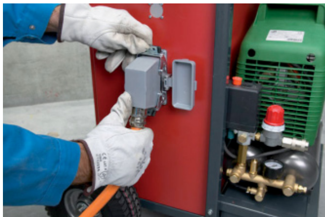
Conecte el cable de alimentación y asegure el enchufe (DS WS10-E).
