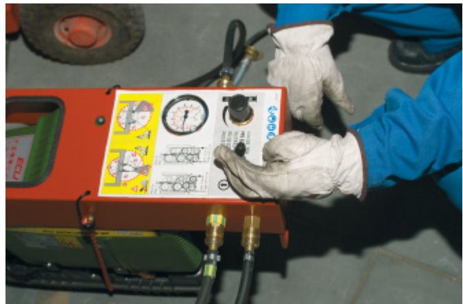
Operación de la válvula de control de avance (DS WS10)
