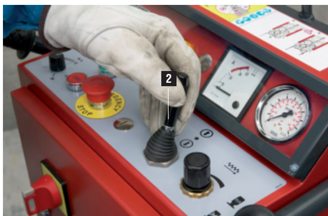
2 Válvula de control de dirección de impulsión (DS WS10-E)
