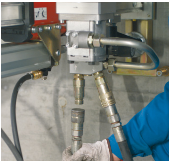
Conexión de las mangueras hidráulicas a la unidad impulsora (DS WS10)
